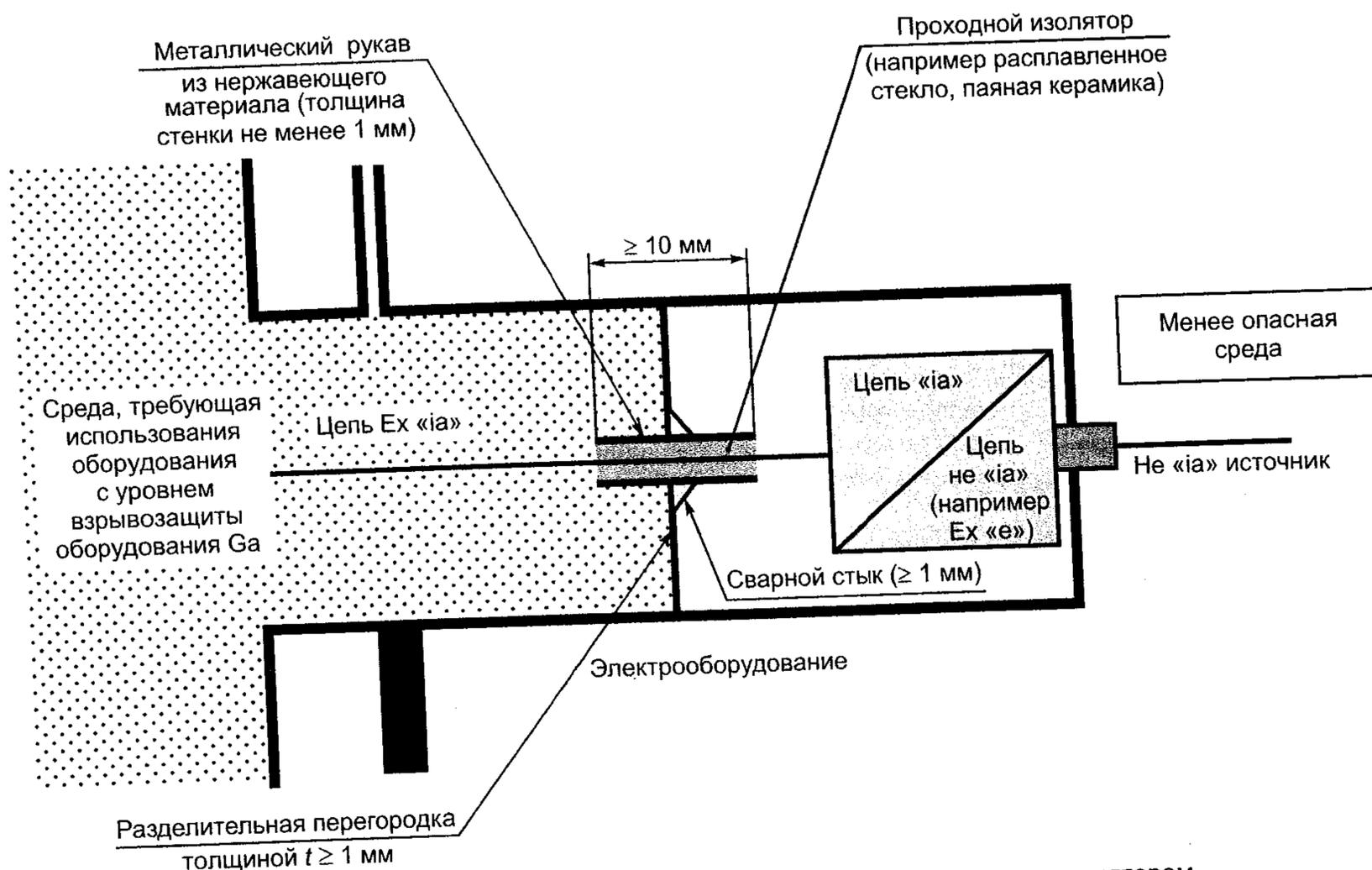
Рисунок 1 — Пример разделительной перегородки с проходным изолятором, препятствующим распространению газа
