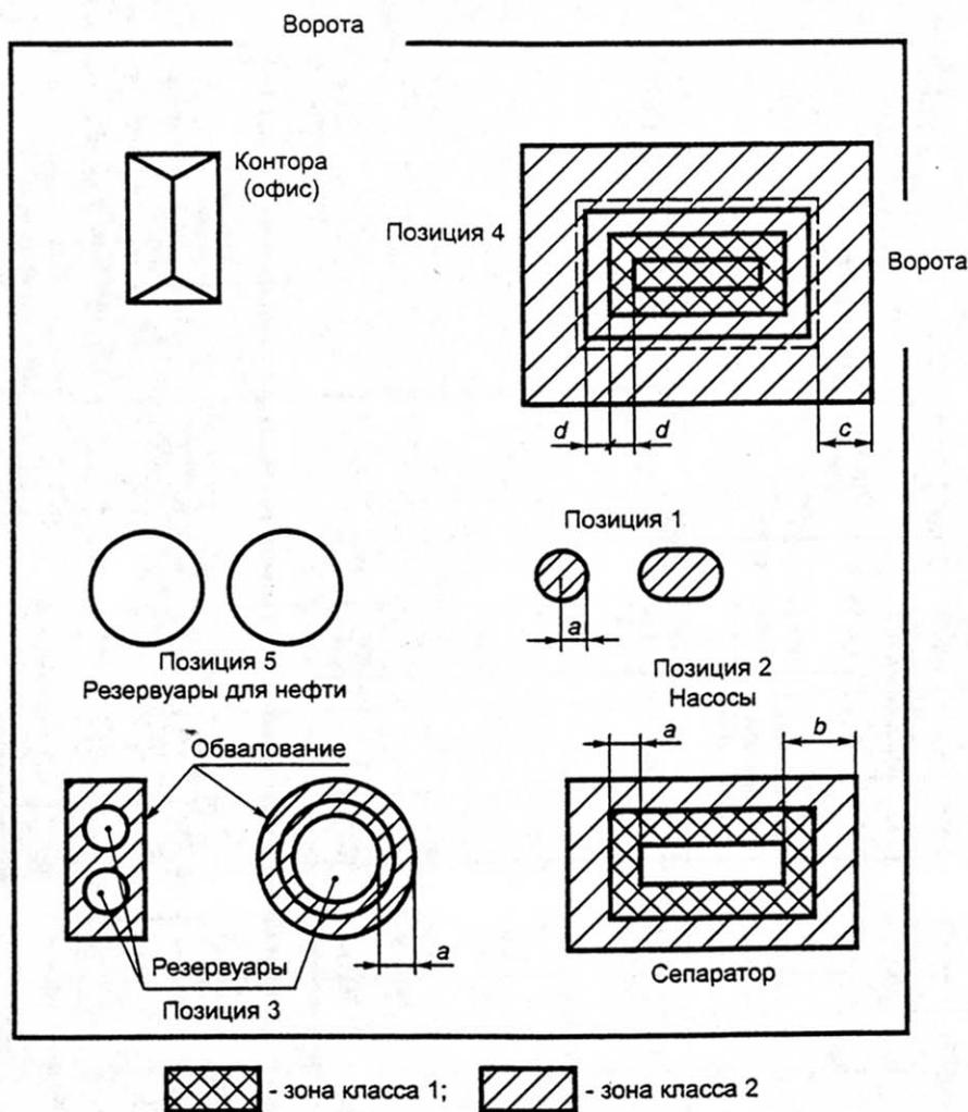
В данном примере показан один из способов применения примеров № 1, 6, 8 и 9. В этом упрощенном примере три резервуара (обвалованные) для хранения бензина (поз. 3), пять насосов для жидкости (поз. 1), установленные вблизи друг от друга, и один отдельный насос (поз. 1), одна установка для заправки автоцистерн (поз. 4), два резервуара для нефти (поз. 5) и один гравитационный сепаратор нефти/воды (поз. 2) расположены в пространстве резервуарного парка.
