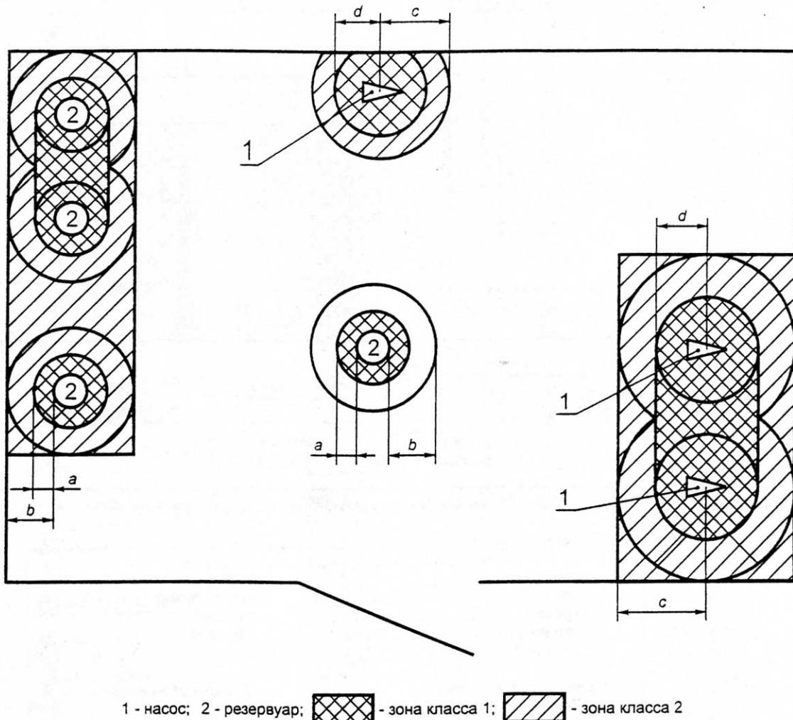
В данном примере для классификации помещения, в котором установлены три насоса для жидкости 1 и четыре резервуара для смещивания красок 2, используются примеры № 2 и 5.
